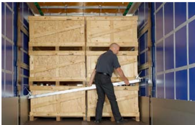
Asigurarea mărfii paletizate – orizontal
